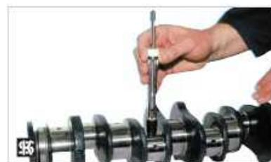
Controle de dureza com durômetro portátil
