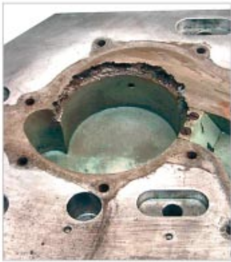
Erosão sobre equipamento de ensaio
