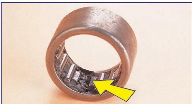
Rolamento danificado ou em mau estado, mantém o eixo piloto girando mesmo com a embreagem desacoplada, dificultando o engate de marchas. Além disso, rolamento do eixo nessas condições, provoca também ruído quando se aciona a embreagem e/ou quando se arranca com o veículo. Por isso, é muito importante verificar cuidadosamente o estado geral e a lubrificação do rolamento em toda troca da embreagem.
