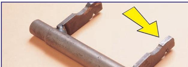
Garfos desgastados forçam o rolamento contra a guia, gerando altas forças de resistência no pedal de embreagem. Portanto, garfos desgastados devem ser prontamente substituídos.
