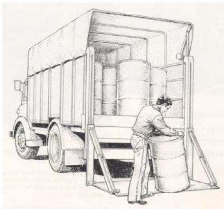
Existem já veículos dedicados exclusivamente a este tipo de transporte, que possuem um monta-cargas (elevador hidráulico) instalado na parte traseira da caixa de carga.
