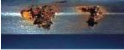
Componentes de má qualidade: Camisas de má qualidade, que pelas suas generosas tolerâncias de fabrico não fiquem correctamente fixas ao bloco do motor, oscilarão dentro deste. Isto produzirá um maior nível de vibrações e o correspondente aumento dos danos por formação de cavidades. Também os materiais de má qualidade podem favorecer este tipo de danos.
